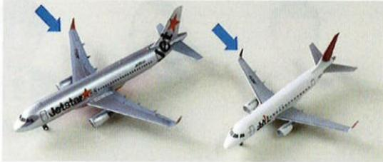
爺：そうじゃ。翼端に発生する渦抵抗<sup>※12</sup>を小さくして、航続距離を改善させる構造じゃ。よく読むと、本件特許はその作用効果がずれているが、渦流 (vortex) 制御に着目している点でウイングレットの元祖じゃ。ただ、ワシが着目したいのは、明細書中の次の記載じゃ。
