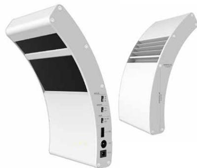
従来技術では検知が難しかった、インシデント行動の初期状態を的確に捉え通知します。就床・起床・離床・不在などの状態を識別し、起床行動や離床行動を的確に報知することで、スタッフの業務効率化をサポートします。
