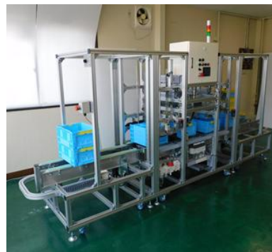
コンテナ折り畳み装置
