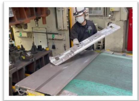
コンベアの動力と金型/コンベアの高低差を有効活用
