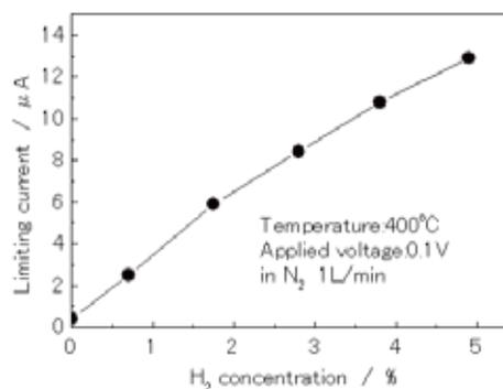
プロトン伝導体に電圧を印加し、サンプルに暴露。素濃度に応じた電流が発生。
