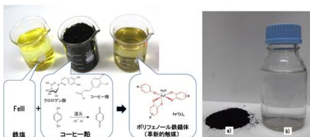
図1 清涼飲料工場から廃棄されるコーヒー粕を用いた触媒の製造 (a) 粉末、(b)液体
